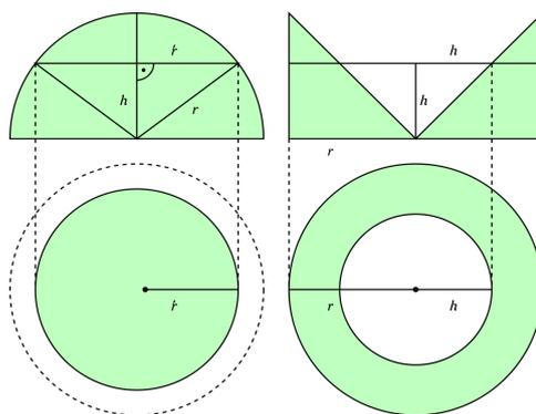
Die oberen Grafiken zeigen jeweils den vertikalen Schnitt durch den Mittelpunkt; die unteren jeweils den horizontalen Schnitt an der Höhe  $h$ .
